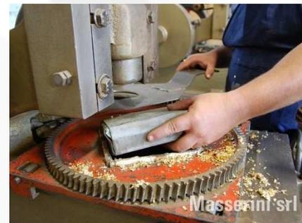
Per ottenere questi fogli si parte da un nastro di tombacco (lega di rame e zinco) o rame di spessore di circa 0,008 millimetri o di 0,010 nel caso dell'alluminio e, mediante successive operazioni di battitura con magli, viene portato alla misura voluta e ad uno spessore finale di circa 0,002 - 0,003 millimetri.
